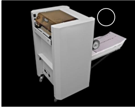
Geeignet für die Produktion von größeren Auflagen wird die SF-3000 Produktlinie komplett aus Metall gefertigt. Die massive und stabile Konstruktion steigert Schnelligkeit und Langlebigkeit. Der ideale „Bookletmaker“ für Schulen, Kirchengemeinden, Vereine und Bildungseinrichtungen. Erstellen Sie Booklets einfach und schnell. Arretierung des jeweiligen Papierformates über mechanisches Einstellrad.
